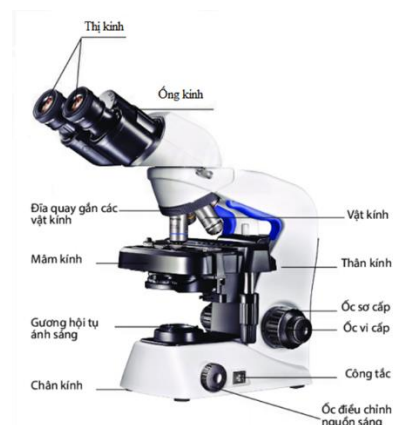
Hình 3.8. Cấu tạo kính hiển vi quang học
