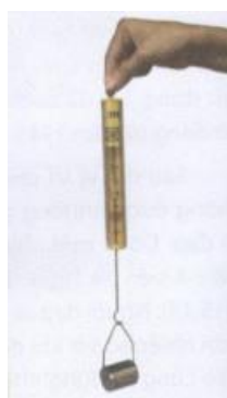
Sau thí nghiệm để luôn quả nặng trên thiết bị rồi treo lên giá đỡ
