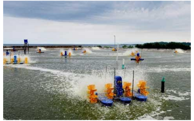
Hệ thống quạt nước trong đầm nuôi tôm
