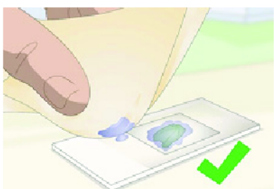
Bước 5. Dùng giấy thấm nước thừa tràn ra ngoài lam kính.
