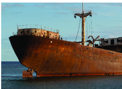
▲ Hình 14.4. Vỏ tàu biển bị ăn mòn
