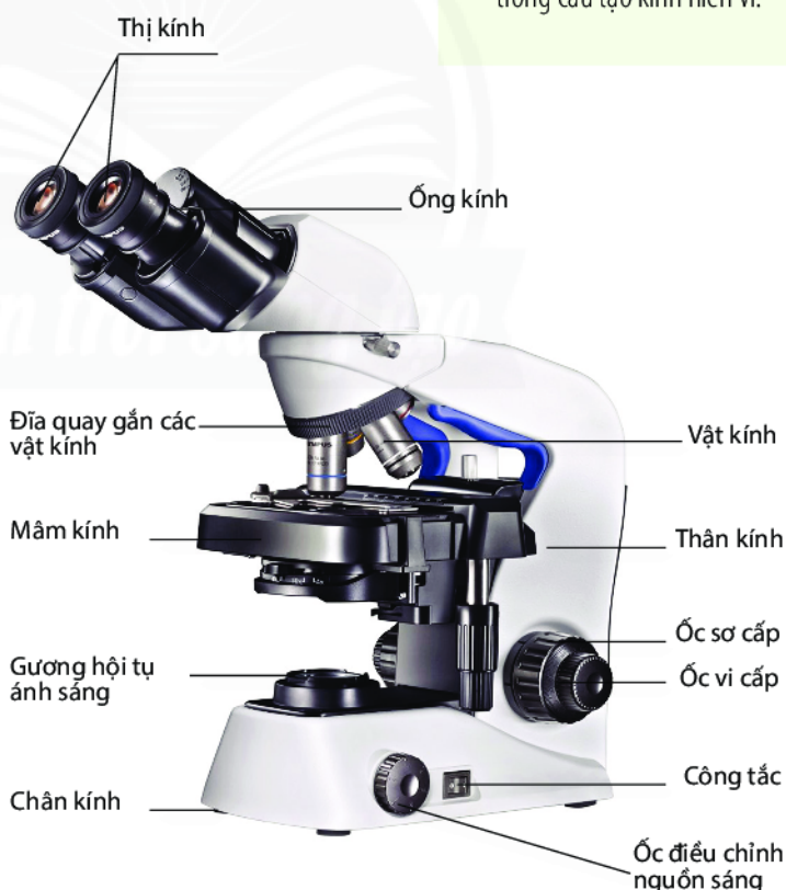
▲ Hình 3.8. Cấu tạo kính hiển vi quang học
