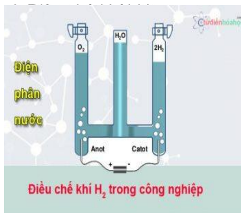
Điều chế hidro bằng cách điện phân nước
