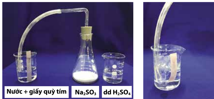
Hình 1.15. Thí nghiệm khí sunfuro tác dụng với nước
