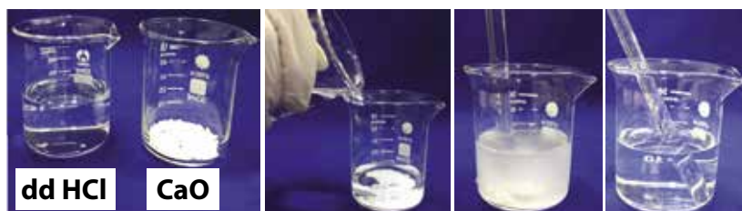
Hình 1.9. Canxi oxit tác dụng với axit clohidric
