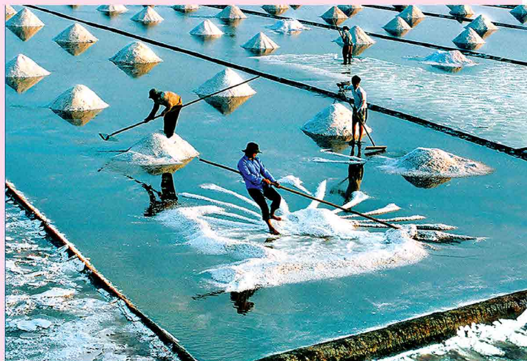
Hình 1.15. Tách muối ăn từ nước biển
