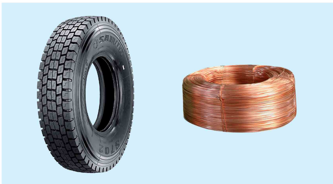
Hình 1.11. Cao su làm vỏ bánh xe ô tô, dây đồng làm dây dẫn điện
