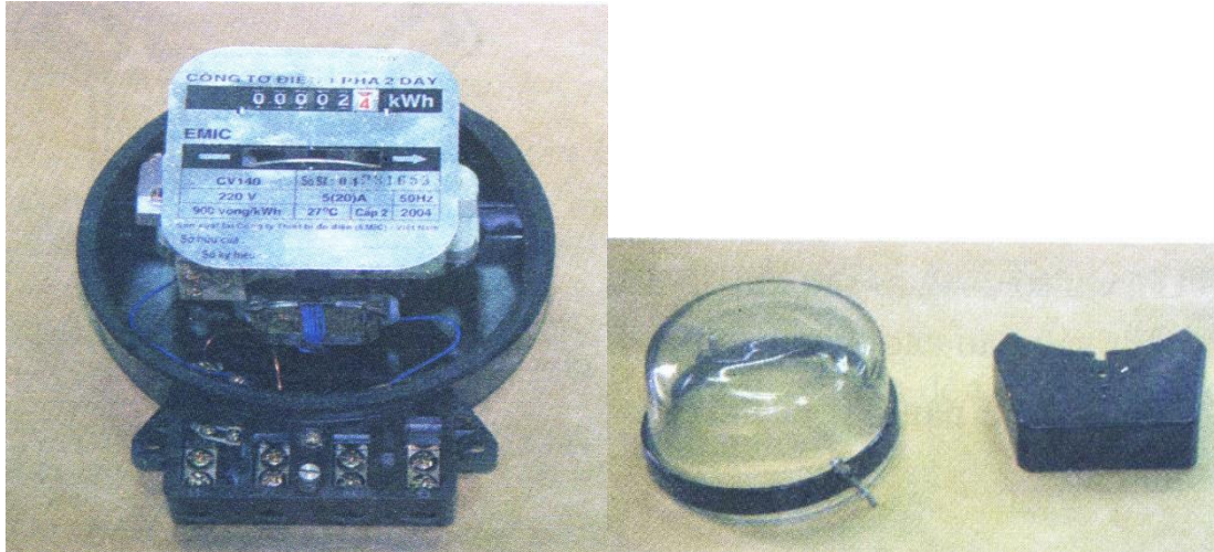
Hình 4-1. Công tơ điện
